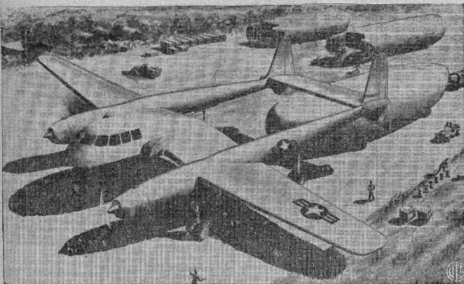
He aquí el concepto de un artista del aeroplano Fairchild desarmable, que estudia el Comando de Material Aéreo. El fuselaje o cabina puede ser cargado mucho antes del vuelo, y enganchado al avión minutos antes del despegue. En el dibujo, uno de los fuselajes es roitrado, mientras los dos del fondo son cargados para futuros vuelos.
